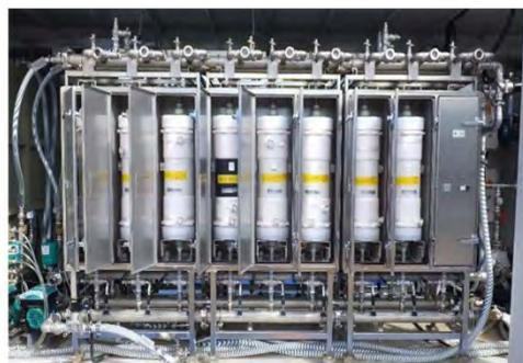
図7. 移動型焼却灰除染設備実証試験現場(福島県)と吸着灰カートリッジモジュール
